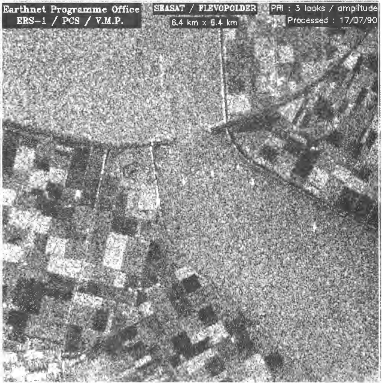
Fig.29: Exemple de speckle sur image radar Zone agricole de Flevopolder (Pays-Bas) Image de SAR aéroporté, 6.4 km X 6.4 km SAR 580, 28 Août 1978, Traitement 3 looks
