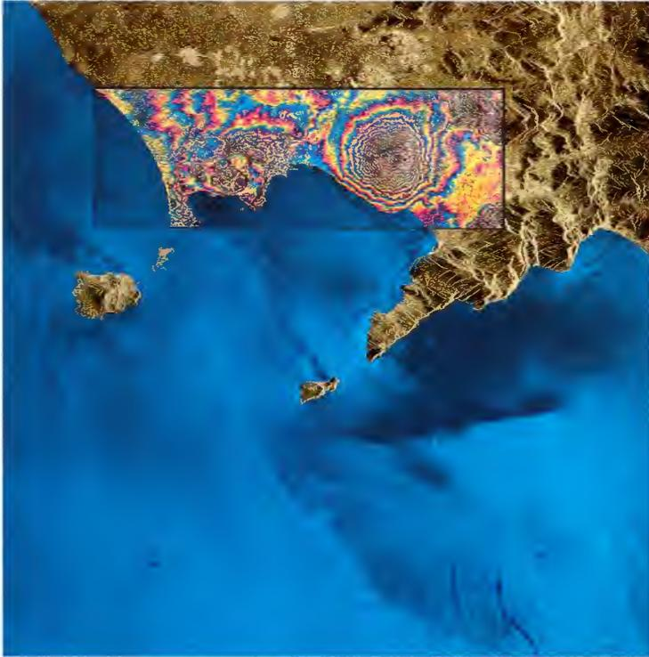
Una tecnica promettente ed entusiasmante di utilizzo dei dati ERS-1 è l'interferometria SAR. Con l'ausilio dell'interferometria è possibile estrarre direttamente dai dati ERS-1 mappe dettagliate e tridimensionali dei rilievi della superficie terrestre con una approssimazione di pochi metri.
