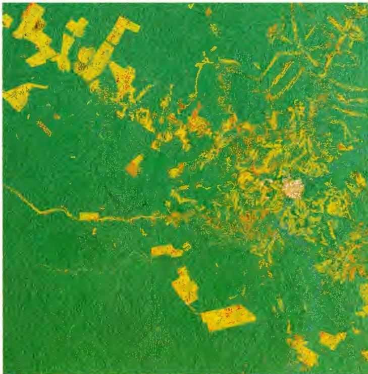
Si assiste alla distruzione delle foreste pluviali tropicali; solo i satelliti sono in grado di quantificare l'impatto dell'attività dell'uomo su questo fragile ecosistema. Questa immagine ERS-1 della zona di Rio Branco, in Brasile, ottenuta tramite la sovrapposizione di due immagini registrate nella primavera 1992 con un intervallo di 35 giorni, mostra i cambiamenti subiti dalla vegetazione in quel periodo.
