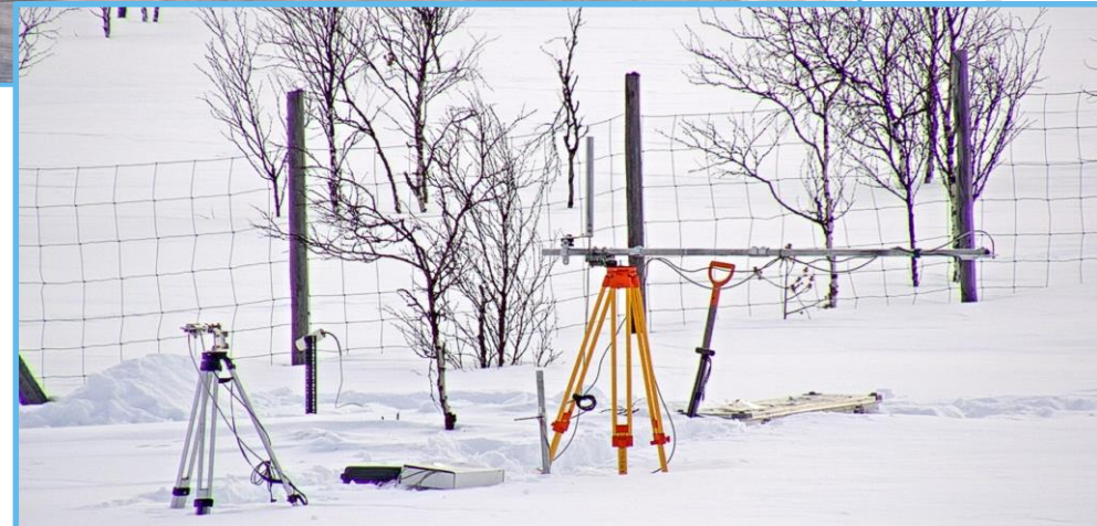
Autosolexs: 350-1050 nm, at 3 nm resolution (Université de Grenoble Alps, France)
