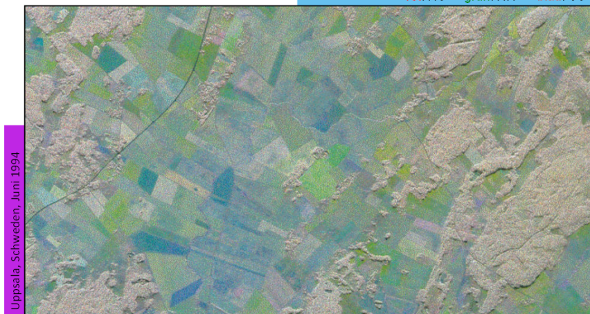
Multipolarimetrische Colour-Komposite in C-Band rot: HV grün: HH blau: VV
